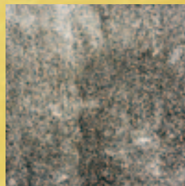
箔打ちをコンピュータで制御していることで独特の模様が浮かびあがる。
