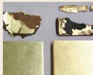
日光東照宮の寛永期金箔・寛政期金箔と当時の金貨を材料にして復元された焦箔・色吉(いろよし)箔手板との色相比較。
