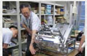
職人の技を可能な限り再現するための自動裁断装置は、数年の歳月と幾度も試作を重ねて実現。箔の新たな境地開拓に期待が寄せられる。
