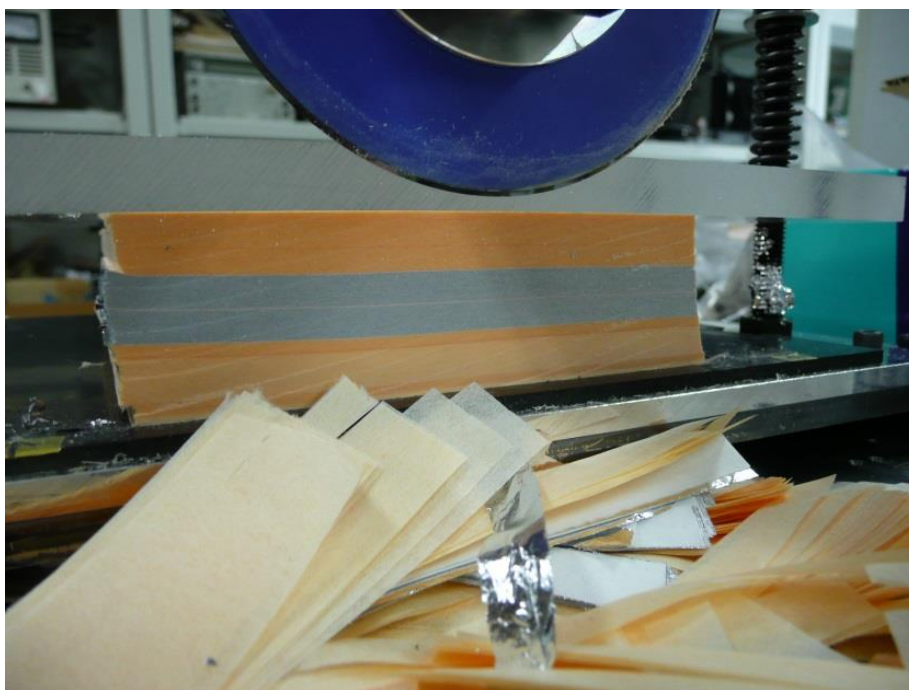
図 4.5 切断（斜め切り）後の積層体断面
