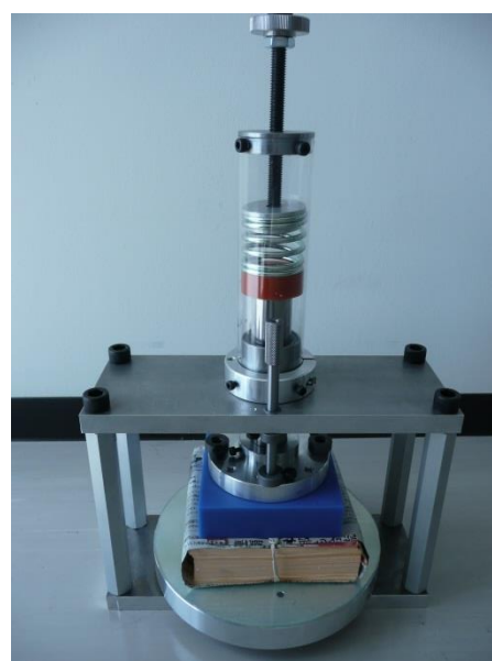
図 5.2 積層体を押し付けたまま回転している様子
