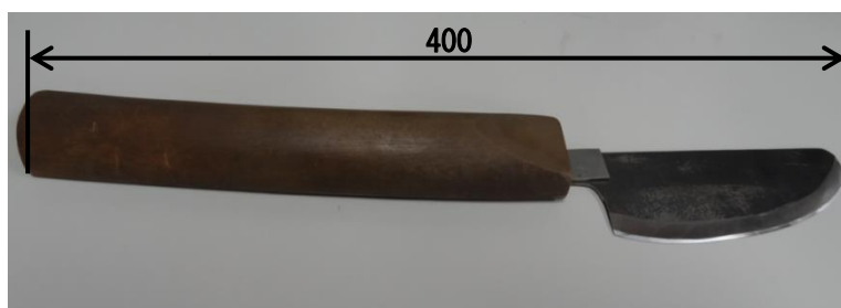
図 1.1 職人が使用している刃（単位[mm]）
