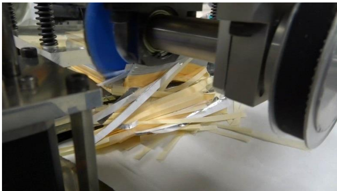
図 4.6 切断（斜め切り）の様子
