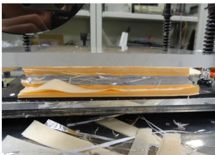
図 3.1 積層体（合紙）の切断結果（切りくずの巻き込み等によりささくれ立っている）
