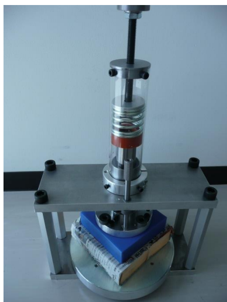
図 5.2 積層体を押し付けたまま回転している様子
