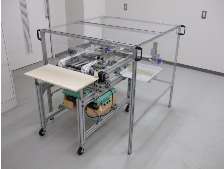
図2 ニゴ採取機試作機と安全カバー
