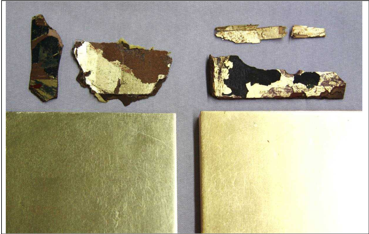
写真 30 : 日光東照宮の寛永期金箔・寛政期金箔と復元焦箔・色吉箔手板との色相比較
