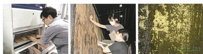
紫外線劣化曝露試験 (資料提供:東京文化財研究所)
