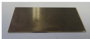
(e) 超微粒子超硬板ナイフ (刃厚:0.25mm 長さ:40mm 刃角:15°材質:FW25)
