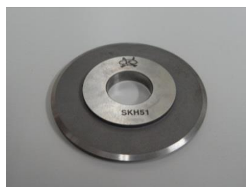
(d) 高速度工具鋼（小） (刃厚：2mm 外径：76mm 材質：SKH51)
