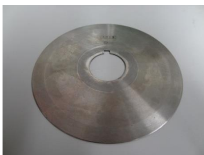
(c) 高速度工具鋼（大） (刃厚：1.2mm 外径：160mm 材質：SKH51)
