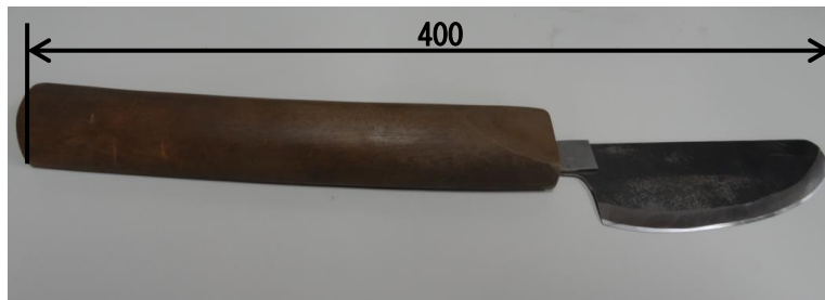
図 1.1 職人が使用している刃（単位[mm]）
