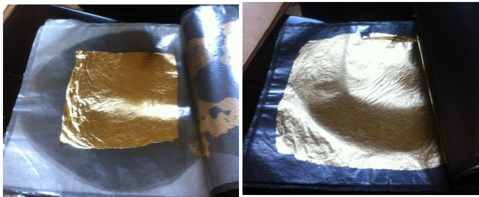
図 7. 実試験（試打）で作製した金箔の写真 (左：試料 NO.60 を使用、右：従来のカーボン塗布グラシン紙を使用)
